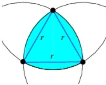
Esta figura curva se llama triángulo de Reuleaux. Evidentemente, la distancia entre cualquier punto de la curva y el vértice opuesto es la misma:  $r$ , por eso se dice que tiene ancho constante. Así pues, una tapa de alcantarilla de esta forma nunca se colaría por el hueco. ¿Y qué ocurre con los botones?, un botón con esta forma tampoco se saldría nunca de su ojal, salvo que, como ocurre con los botones circulares, el ojal se estire ligeramente para dejarles salir.
